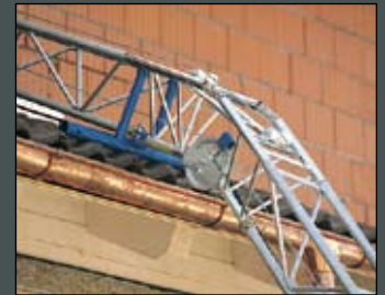
Neigung stufenlos von 0°-70° einstellb.
